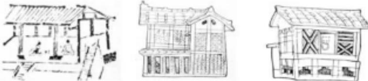
抬梁式結構、穿斗形結構、和檻式結構（圖片來源《中國古代建築史》，漢廣德提供）
